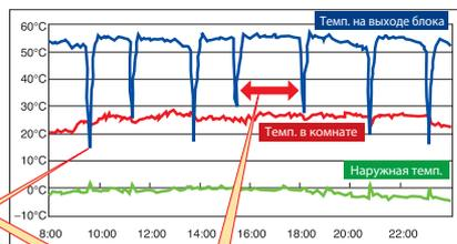
Благодаря специальным алгоритмам управления интервал между режимами оттаивания увеличен до 150 мин (при температуре наружного воздуха в диапазоне от  $-20^{\circ}\text{C}$  до  $0^{\circ}\text{C}$ )
