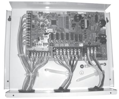
Контроллер PAC-IF031B-E предназначен для управления тепловыми насосами «воздух–вода» полупромышленной серии Mr. Slim, а также исполнительными устройствами контура теплоносителя: циркуляционным насосом, 3-ходовым клапаном, двухсекционным электродкотлом, электронагревателем бойлера.
