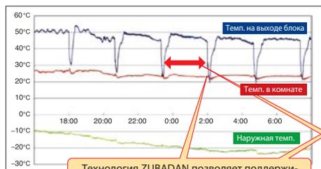
Технология ZUBADAN позволяет поддерживать в помещении постоянную температуру вне зависимости от температуры на улице.
