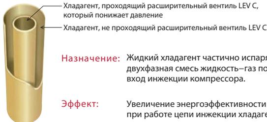
**Назначение:** Жидкий хладагент частично испаряется, и двухфазная смесь жидкость-газ подается на вход инъекции компрессора.
