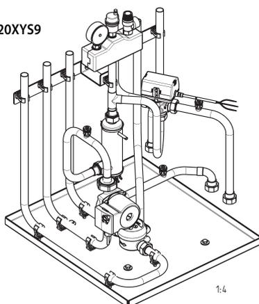
Подключение гидро модуля (вид сверху)
