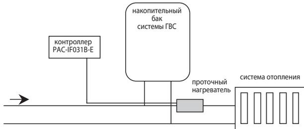
г) Проточный электрический нагреватель установлен таким образом, что обеспечивает увеличение температуры воды только в системе отопления. Накопительный бак оснащен погружным электрическим нагревателем.
