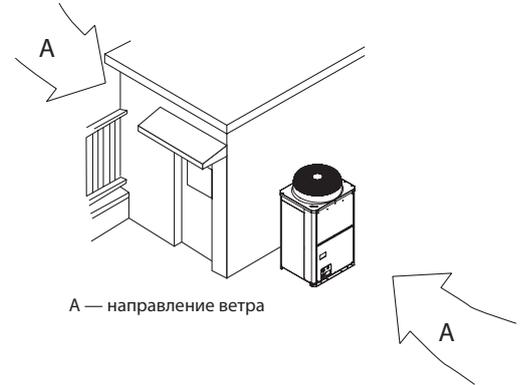
б) Выбирая место для установки наружного блока, расположите его так, чтобы ветер преимущественного направления не воздействовал на теплообменник; расположите блок передней панелью к направлению ветра.
