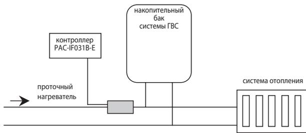
б) Проточный электрический нагреватель установлен таким образом, что обеспечивает увеличение температуры воды в системе отопления, а также в накопительном баке ГВС. Накопительный бак оснащен погружным электрическим нагревателем.
